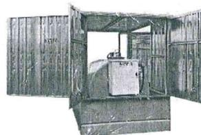
I serbatoi sono del tipo ad asse orizzontale, cilindrici, costruiti con fondi bombati e lamiera calandrata in acciaio al carbonio S 235 JR UNI EN 10025, assemblati mediante processo di saldatura ad arco sotto protezione di gas e successivamente trattati con uno strato di antiruggine ed uno strato di smalto a finire di colore verde; sono collaudati a tenuta mediante prova pneumatica.
