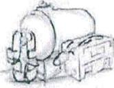
Funzionamento: Il Level monitor contiene i coefficienti di espansione volumetrica propri del prodotto selezionato. Quindi tramite una formula matematica in base al volume reale e alla temperatura misurata dalla sonda è in grado di calcolare il volume compensato (a 15°C).
